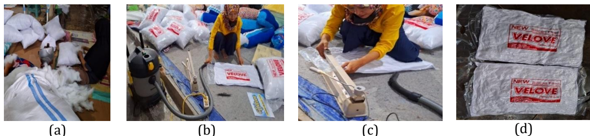
Gambar 2. Proses produksi usaha mikro Velove (a) Pengisian dakron, (b) Proses Vakum, (c) Sealing kemasan dan (d) Bantal hasil vakum siap jual
