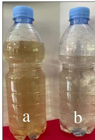
Gambar 4. a) Air Sebelum Proses Penjernihan, b) Air Setelah Proses Penjernihan
