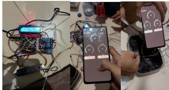
Gambar 4. Proses testing perangkat untuk pembuatan modul IoT Penyiram Air Otomatis
