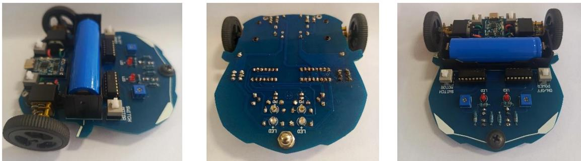
Gambar 3. Robot *Line Follower* yang telah dirangkai.
