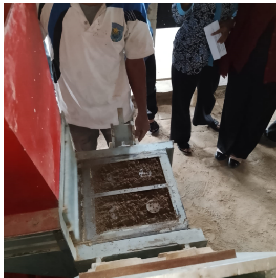
Gambar 4. Pengepresan adonan tanah liat menjadi bata
