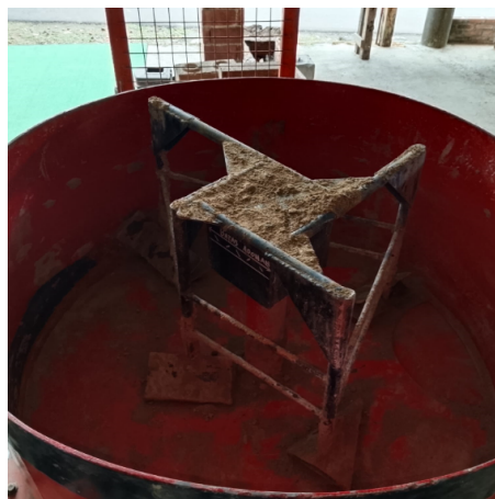
Gambar 2. Pencampuran bahan tanah laterit, potongan limbah plastik, dan semen
