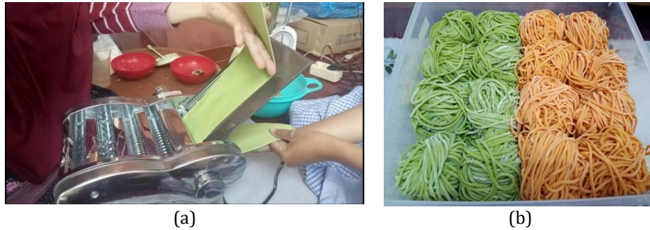
Gambar 3. a) Mencetak lembaran mie dengan cetakan mie elektrik, b) hasil cetak mie
