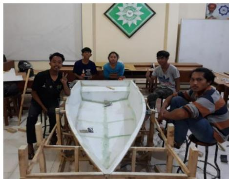
Gambar 2. Proses peletakan triplek melamin ke dalam rangka untuk membentuk cetakan
