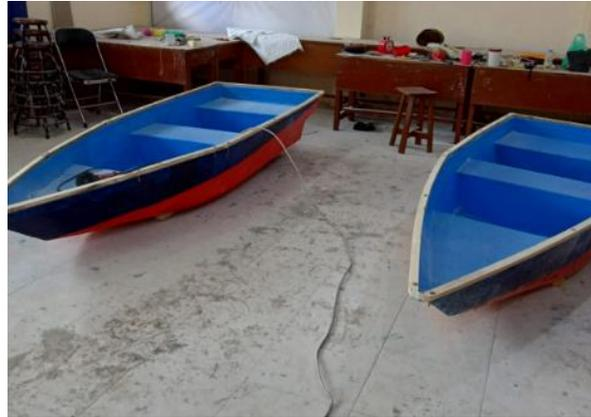
Gambar 4. Proses pelepasan perahu *fiber glass* dari cetakan
