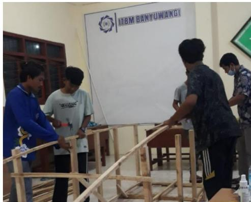
Gambar 1. Pembuatan rangka perahu dari kayu sengon
