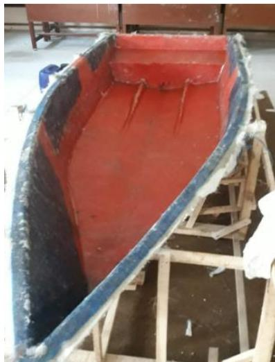
Gambar 3. Proses pengeringan perahu fiber setelah *hand lay-up*
