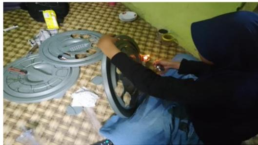
Gambar 1. Proses Pemberian Lubang Pada Tutup Ember
