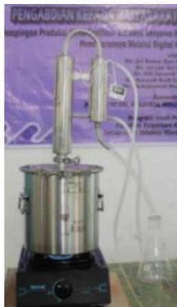
Gambar 1. Seperangkat alat distilasi uap-air yang diintroduksikan kepada Mitra
