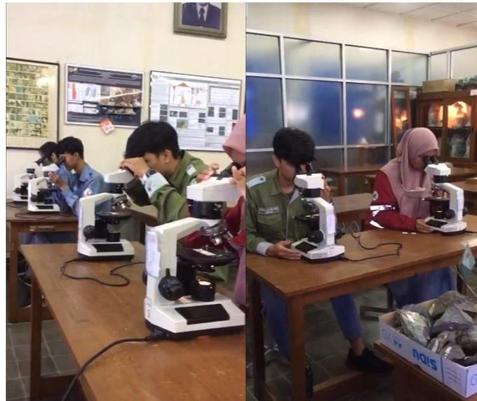
Gambar 2. Para siswa sedang berlatih menggunakan mikroskop polarisasi dan pengamatan sifat optis mineral di bawah pengamatan mikroskop.
